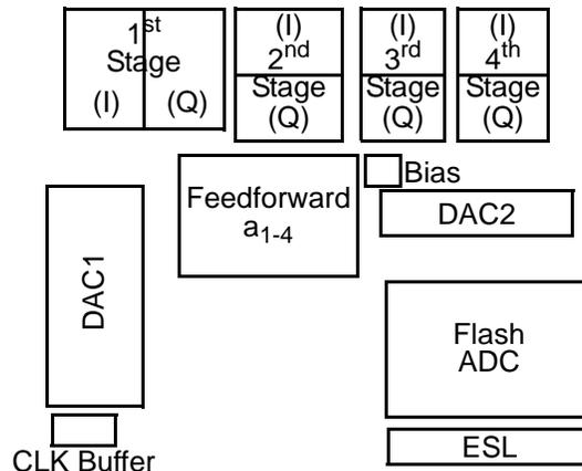
**Fig. 5.14** Modulator floor-plan.
