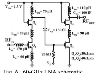
Fig. 6. 60-GHz LNA schematic.
