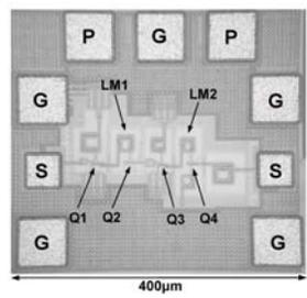
Fig. 9. Die photo of LNA (350  $\mu\text{m}$  x 400  $\mu\text{m}$ ).
