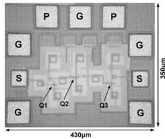
Fig. 8. Die photo of PA (350  $\mu\text{m}$  x 430  $\mu\text{m}$ ).
