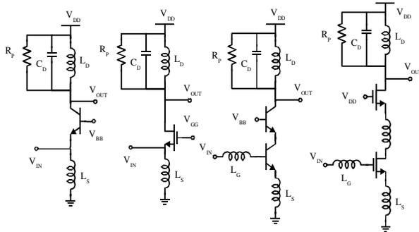
Figure 2. Mm-wave LNA topologies
