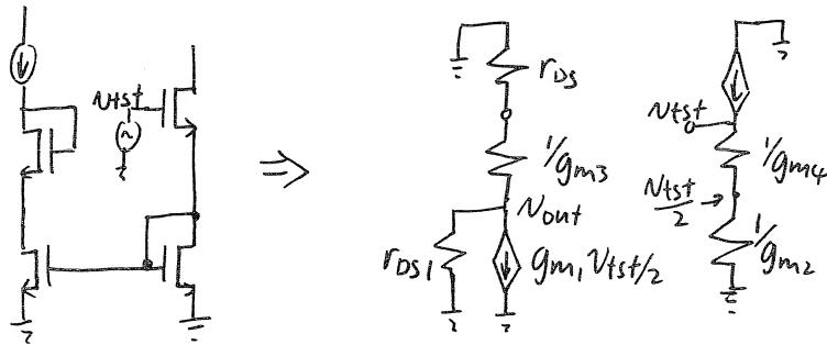
$$V_{out} = -g_{m_1} \times \frac{V_{tst}}{2} \times (r_{DS1} // r_{DS})$$
