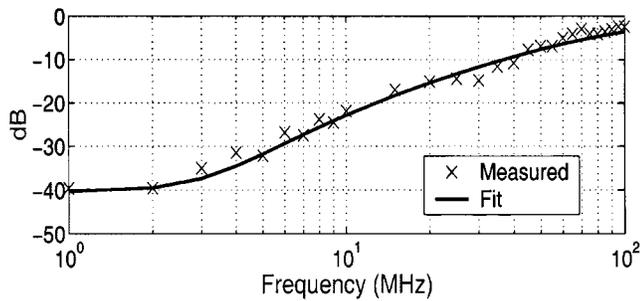
Fig. 13. Gain deviation: dB ( $V_o/V_i - 1$ ).
